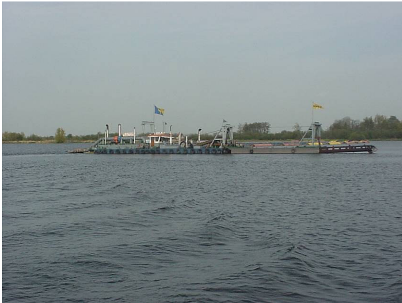
Figuur 17 Voorbeeld van een onderzuiger zoals die ingezet kan gaan worden
