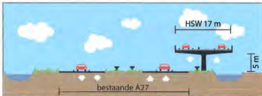
Figuur 46: Principe dwarsprofiel alt. D de HSW naast bestaande A27.
