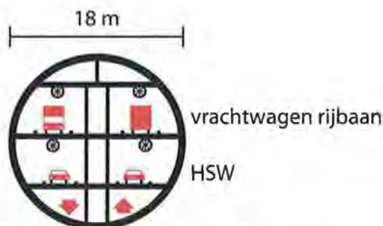
Figuur 49: Verbeterd dwarsprofiel HSW tunnel onder de Merwede (Alt. D)
