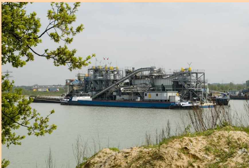
Figuur 2.5: Links: de 'Rotterdam 55' is de grootste moderne drijvende win- en veredelingsinstallatie van Dekker Van de Kamp die kan worden ingezet voor verwerking van gewonnen zand. Dekker Van de Kamp beschikt ook over kleinere installaties voor dit werk. De Rotterdam 55 is als uitgangspunt gebruikt voor dit MER. Rechts: de elektrische zandzuiger 'Rotterdam 58' aan het werk
