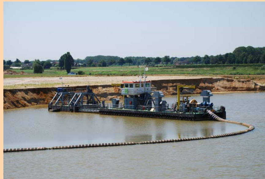
Figuur 2.5: Links: de 'Rotterdam 55' is de grootste moderne drijvende win- en veredelingsinstallatie van Dekker Van de Kamp die kan worden ingezet voor verwerking van gewonnen zand. Dekker Van de Kamp beschikt ook over kleinere installaties voor dit werk. De Rotterdam 55 is als uitgangspunt gebruikt voor dit MER. Rechts: de elektrische zandzuiger 'Rotterdam 58' aan het werk
