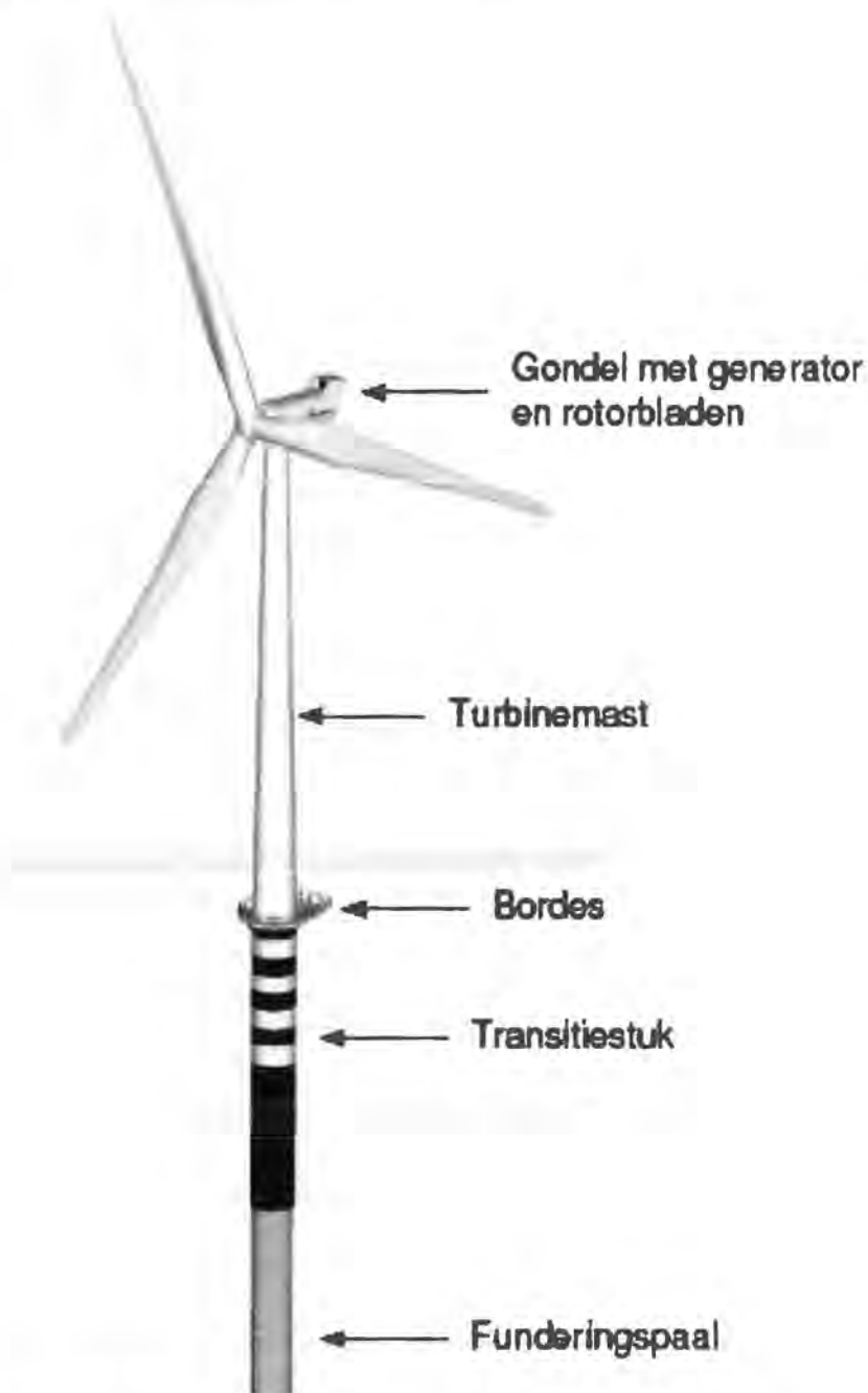
Afbeelding 3-1 Schematische opbouw van een offshore windturbine
