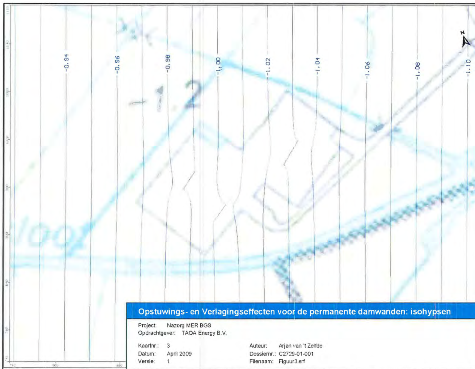
Figuur 5: Isohypsen (in m t.o.v. NAP) van de opstuwings- en verlagingseffecten van de permanente damwanden
