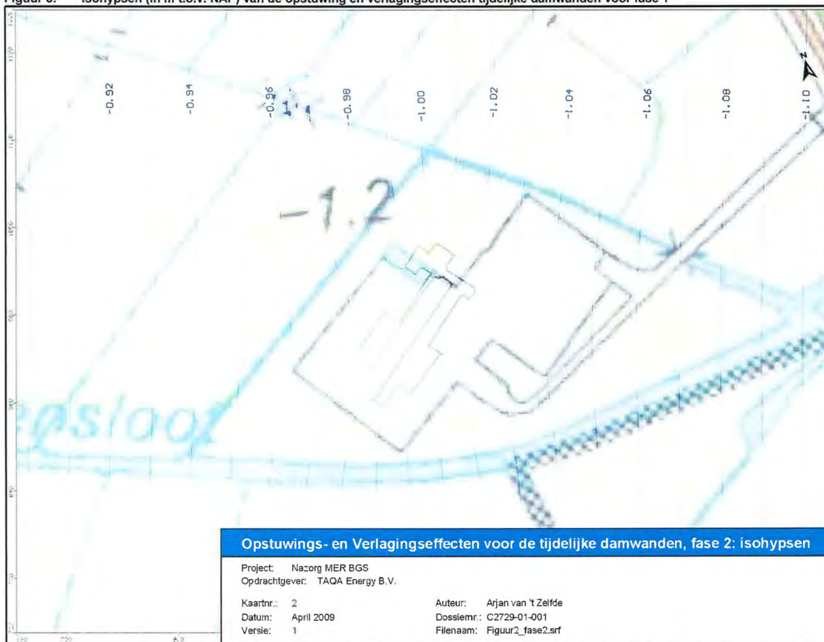
Figuur 4: Isohypsens (in m t.o.v. NAP) van de opstuwing en verlagingseffecten tijdelijke damwanden voor fase 2
