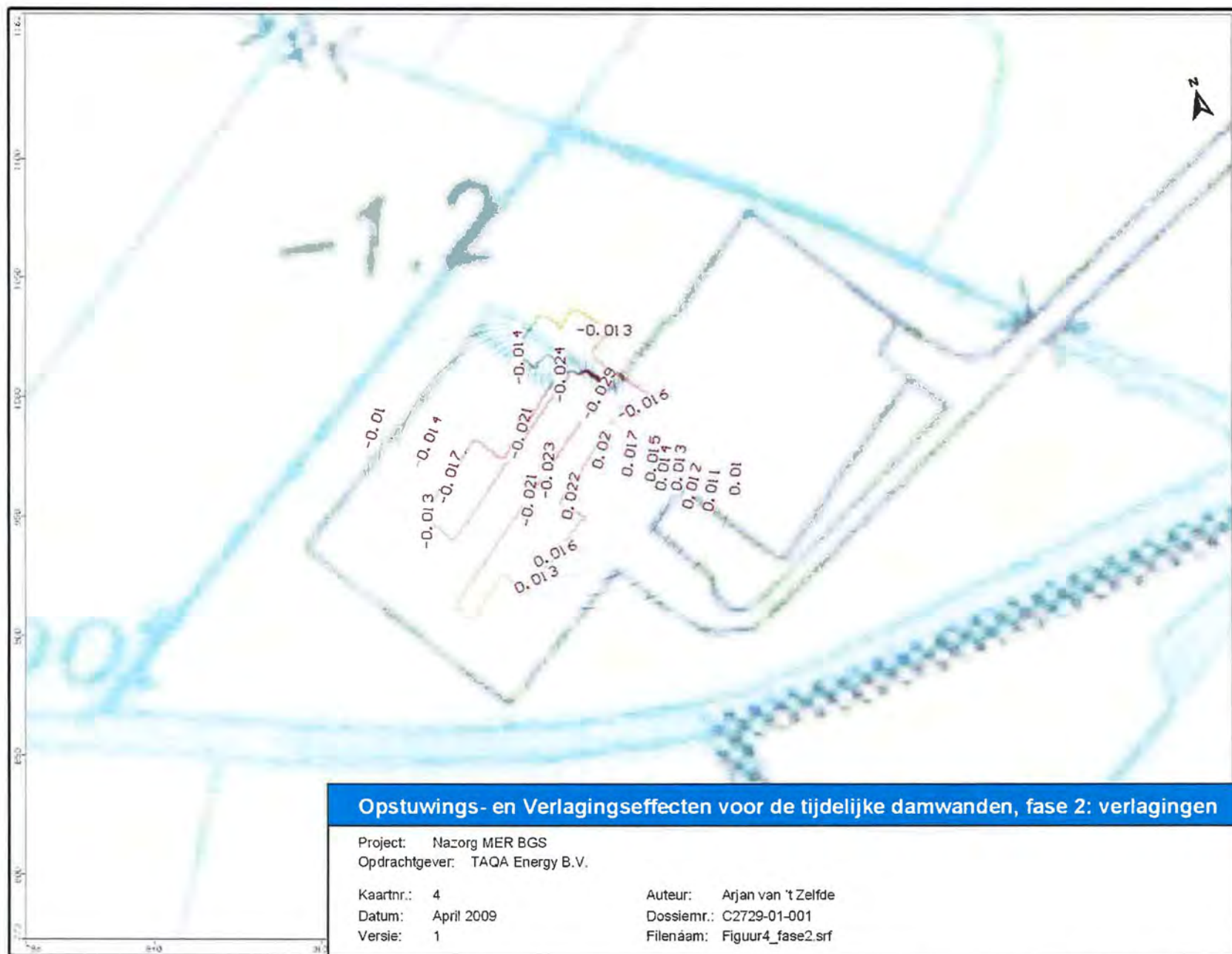
Figuur 6: Grondwaterverlagingcontouren fase 2 met daarin de verlaging in m t.o.v. het ongestoorde peil. Negatieve waarden geven verhogingen aan.
