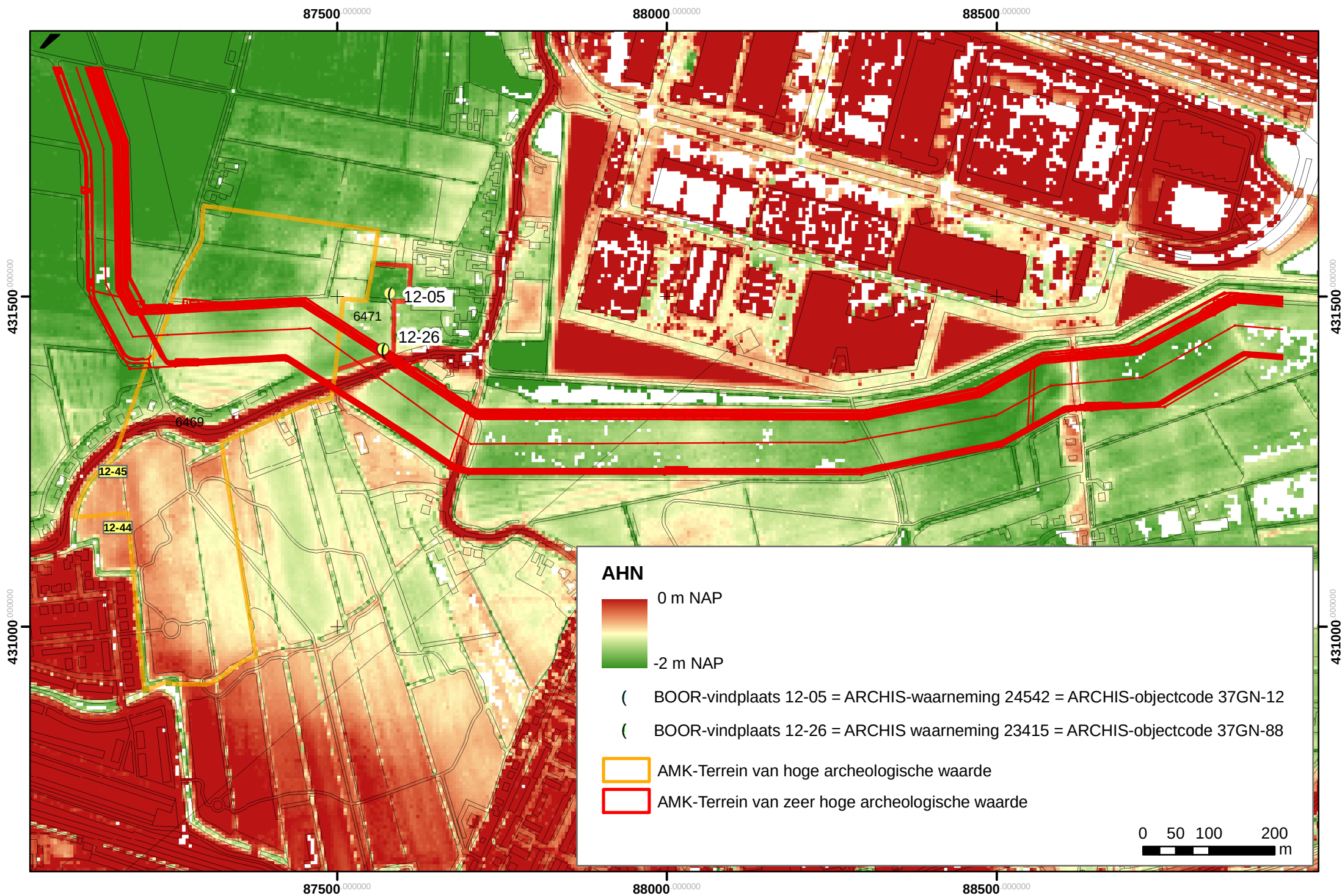
Bijlage 2. Tracé van de buisleidingenstraat op het AHN met aanduiding van AMK-terreinen en vindplaatsen op het terrein van Slot Valkenstein.
