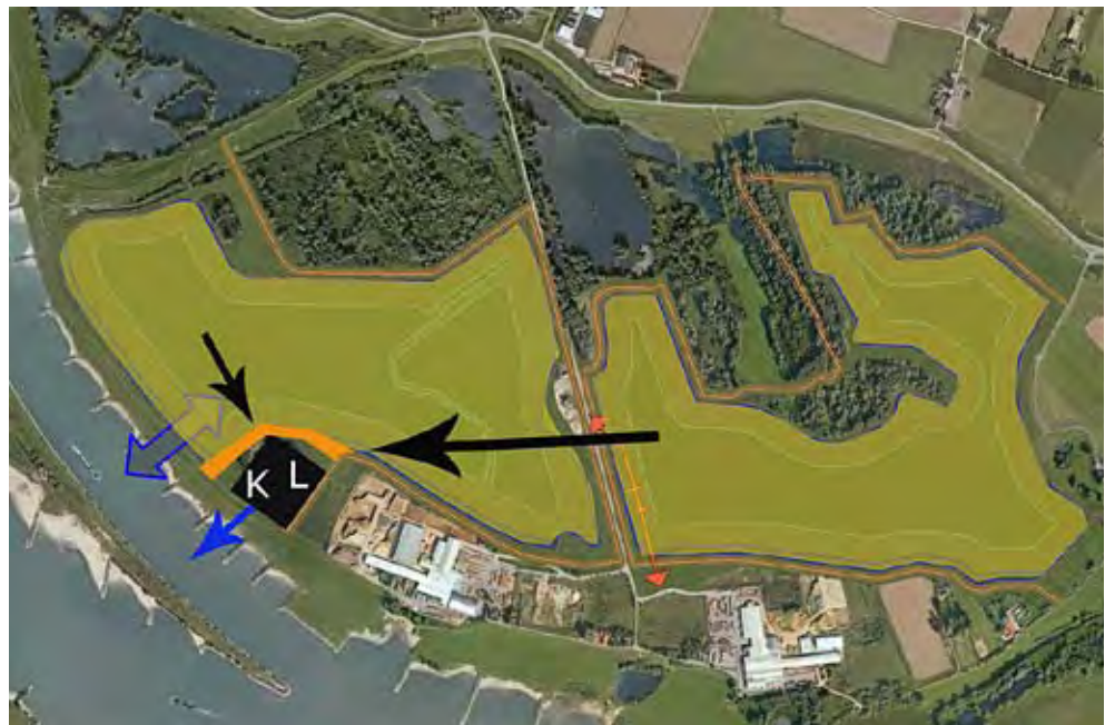
Figuur 36 Situatie variant 4B: de zwarte pijlen geven het verplaatsen van specie weer, de blauwe pijl de afvoerlocatie met schepen over de rivier (bron: Samenwerking Lobberdense Waard)
