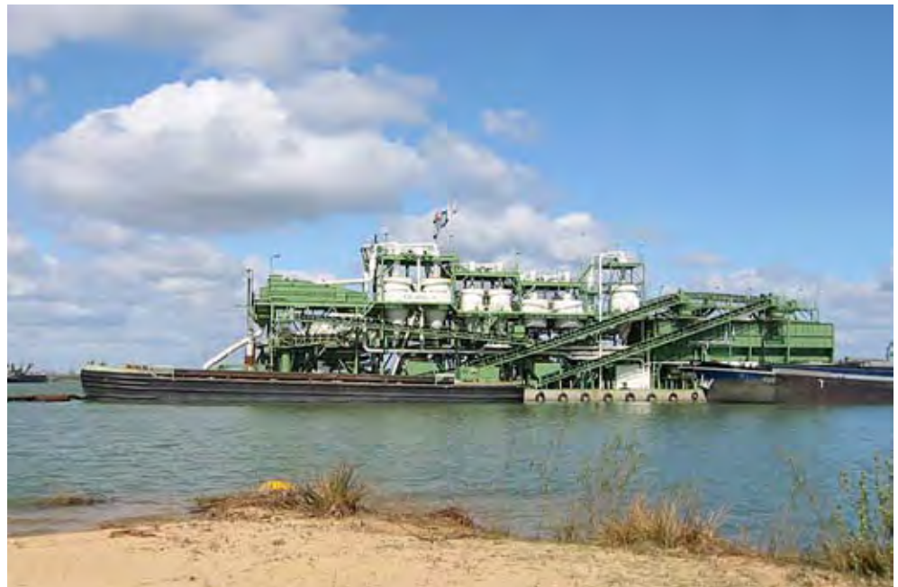
Figuur 14 Afbeelding Zandzuiger en Drijvende klasseerinstallatie (bron Samenwerking Lobberdense Waard)
