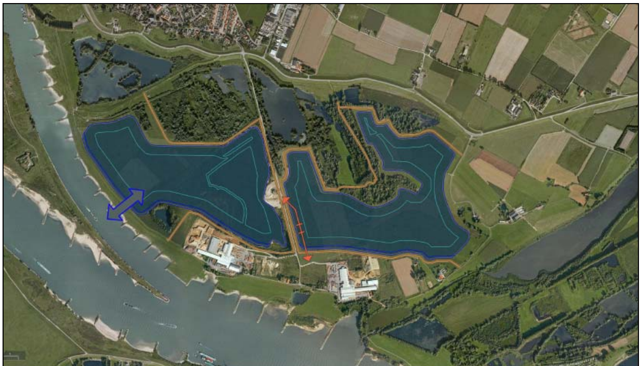
Figuur 2.1: Maximale contour ontgronding interimfase
