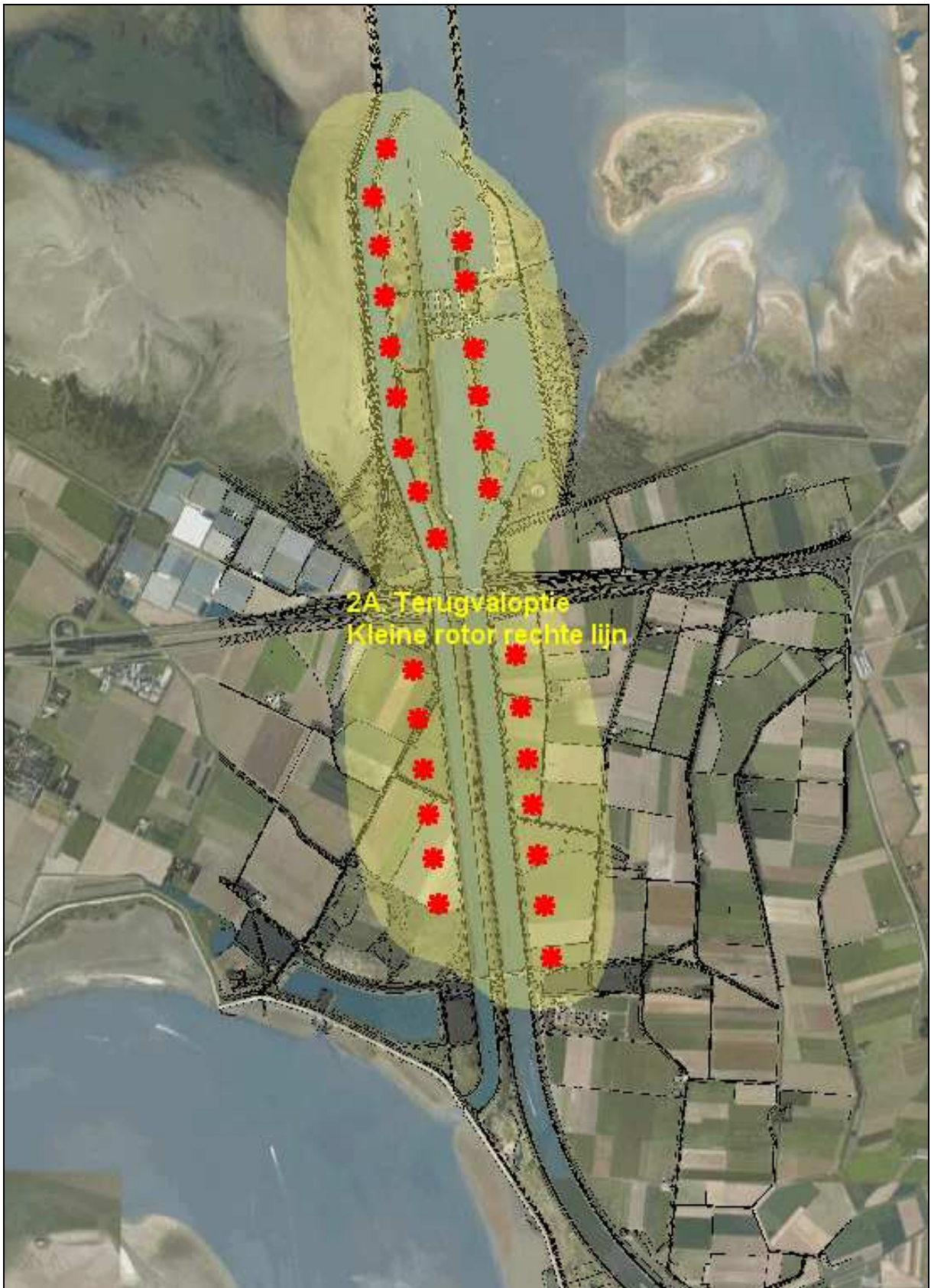
Figuur II.3 Alternatief 2A: geluidcontour gelijk L_{nacht} = 40 dB(A)
