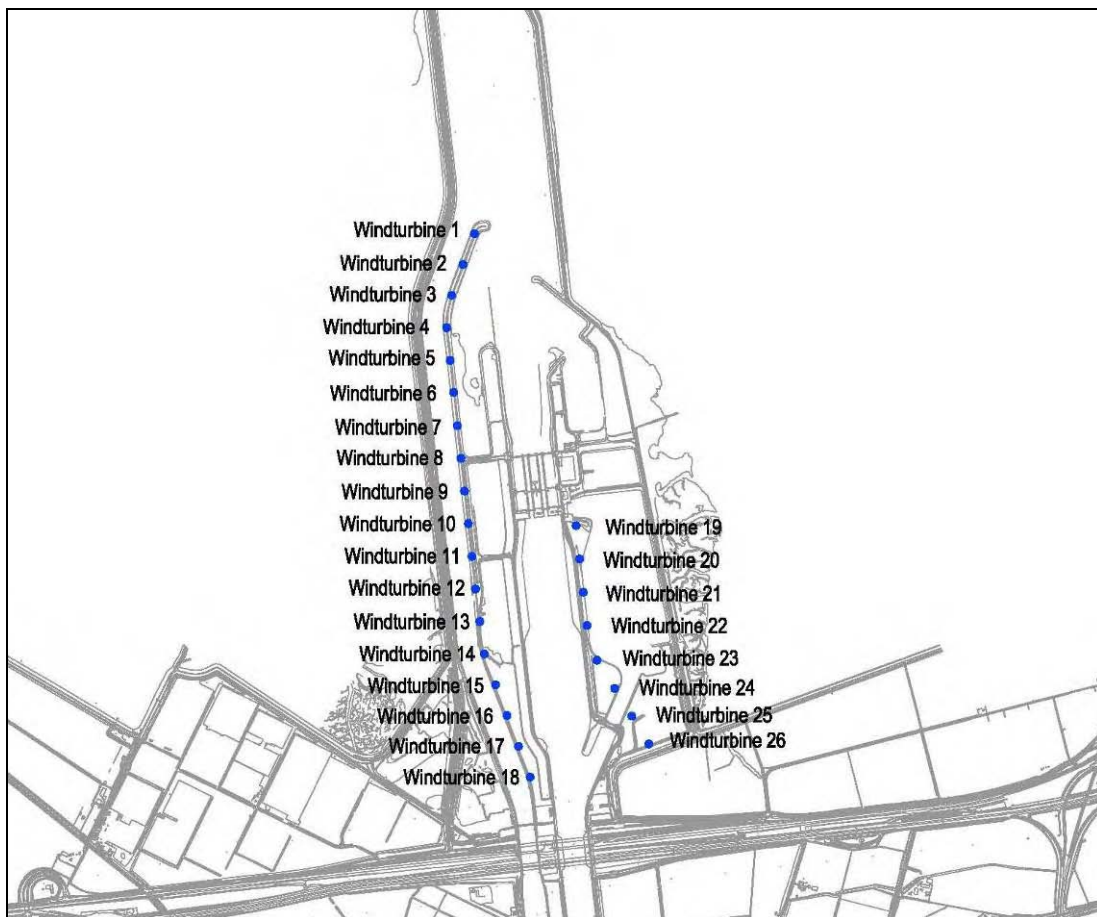
Figuur 2.3. Autonome ontwikkeling: vernieuwen van de bestaande 26 windturbines vermogen 0,8MW (ashoogte 40 meter, rotordiameter 54 meter,)
