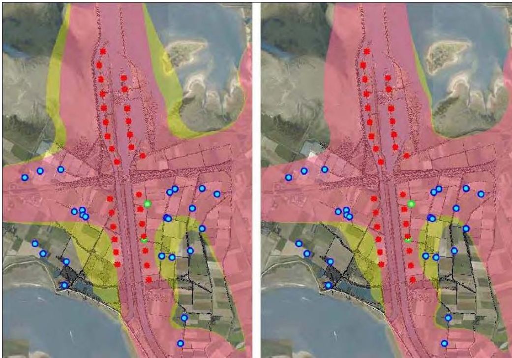
Figuur 8.4. De cumulatieve nachtelijke 40 dB(A) contouren bij autonome ontwikkeling (roze) en na realisatie van alternatief 1 (gele kleur) met mitigerende maatregelen. (Twee verschillende windturbines: links V90 en rechts E70) (Bron: Lichtveld Buis & Partners, 2009).
