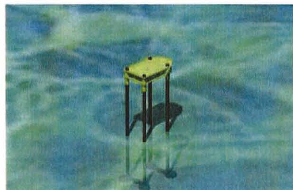
6. Verwijderen van het dek en hijsinstallatie.
