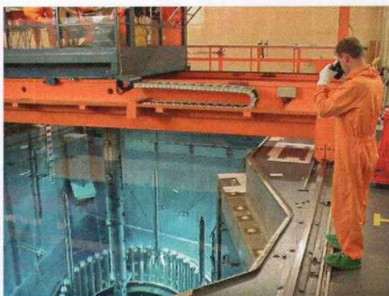
Figuur 2.4 De geopende reactor tijdens de jaarlijkse splijtstofwisseling
