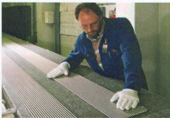
Figuur 4.1 Controle van splijtstofstaven in de splijtstofabriek (foto: AREVA NP)
