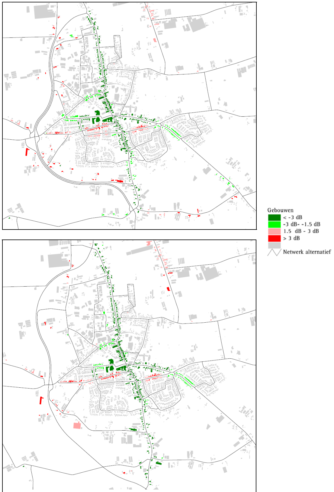
Figuur 8.12: Toe- en afname van de geluidsbelasting in alternatief 1 (boven), alternatief 2A (onder) ten opzichte van de autonome situatie
