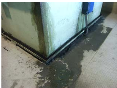
Smeerolie in de behuizing van de tandwielkast
