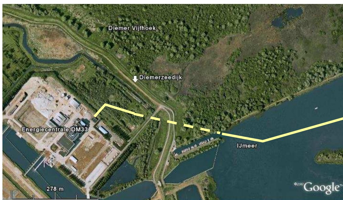
Figuur 4.3 Overzichtsfoto westelijk landdeel watertracé met de energiecentrale van de Nuon, de primaire waterkering en zuidoostelijke punt van de Diemer Vijfhoek. De gele lijn geeft bij benadering het tracé van de leiding weer. Ter hoogte van de streeplijn wordt de leiding onder de Diemerzeedijk geboord.
