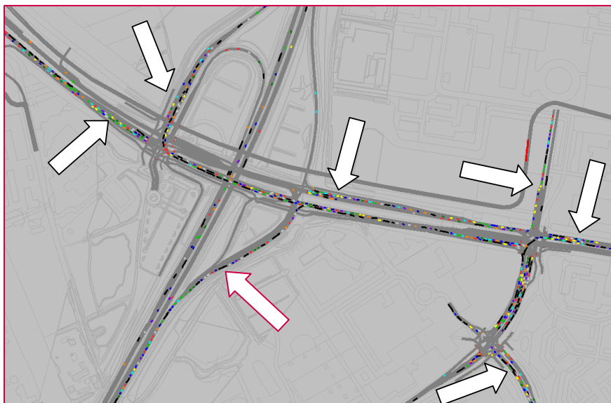
Figuur 5.2: Karakteristieke momentopname van de verkeersafwikkeling op Knoop Leiden West, referentiesituatie 2020 avondspits (bron: VISSIM-simulatie)
