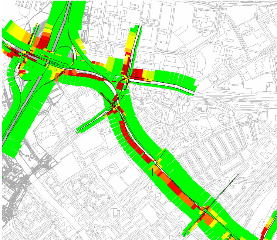
Figuur 8.2: Oorzaken knelpunten in de verkeersafwikkeling in variant Churchill Avenue, avondspits 2030 (rond 16.30 uur)
