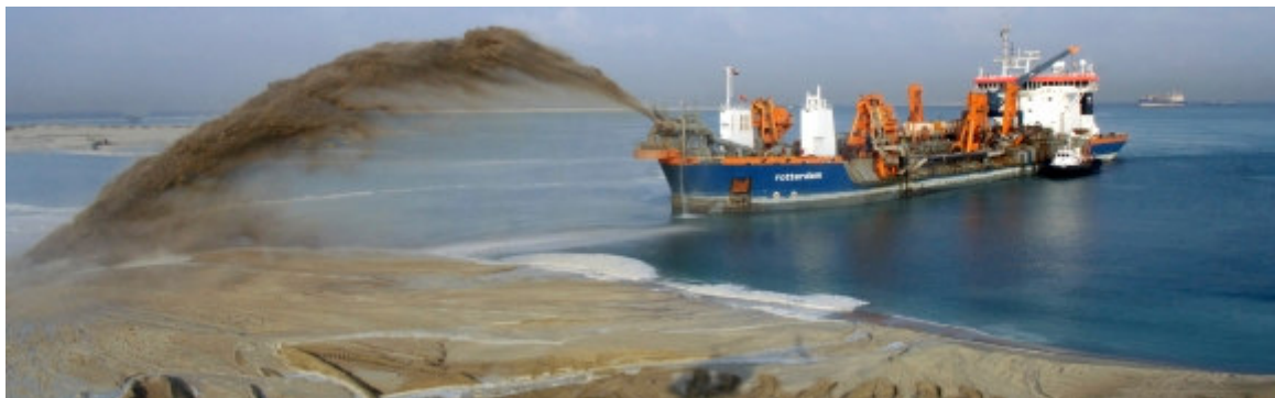
Figuur 2 Een baggerschip aan het rainbowen; één van de manieren om zand te verplaatsen
