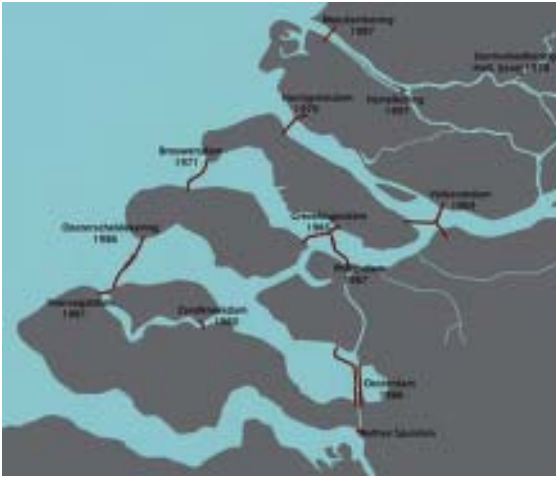
◀ FIGUUR 17 Het estuarium is door de Deltawerken ingrijpend gewijzigd. Het watersysteem veranderde van een samenhangend stelsel getijdenwateren in afzonderlijke en gescheiden waterbekkens, vrijwel geheel geïsoleerd van rivier en zee.
