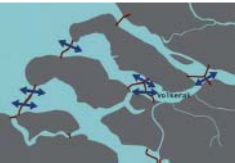
FIGUUR 23 Meer invloed van de zee en de rivier. De dammen aan beide zijden openen, waardoor zee en rivier beide weer toegang hebben tot het Volkerak. Het Volkerak vormt weer de schakel tussen de rivier en de zee. Wenselijk maar op korte termijn niet mogelijk.
