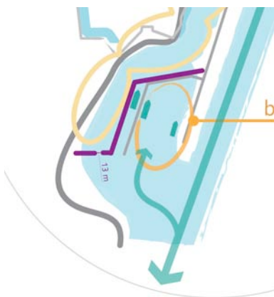
Optie E2 (uitsnede); keermiddel volgt de beroepssteiger zodanig dat dubbelzijdig gebruik mogelijk blijft, smalle doorvaartopening (13 m)
