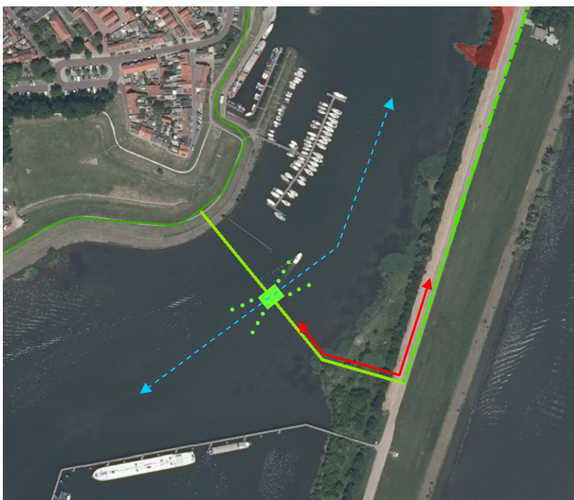
Figuur 5-1: voorstel locatie keersluis - rode pijl = toegangsroute naar keersluis
