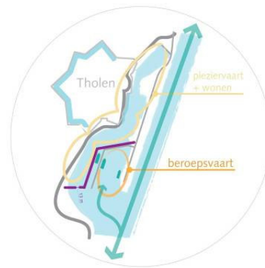
Optie E2: lange langsdam met doorvaartopening 13 m
