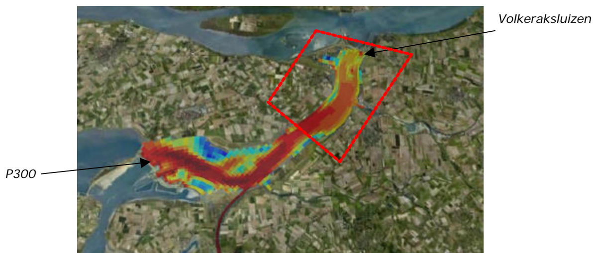
Figuur 3-1 Instromend zoet water in een zout Volkerak-Zoommeer, 2 dagen na opening van de Volkeraksluizen. Getoond is de dichtheidsverdeling nabij de bodem van het meer (blauw komt overeen met een dichtheid van 1005 \text{ kg/m}^3 , rood met 1020 \text{ kg/m}^3 ). Het rood omstippelde gebied is verder onderzocht in Figuur 3-2
