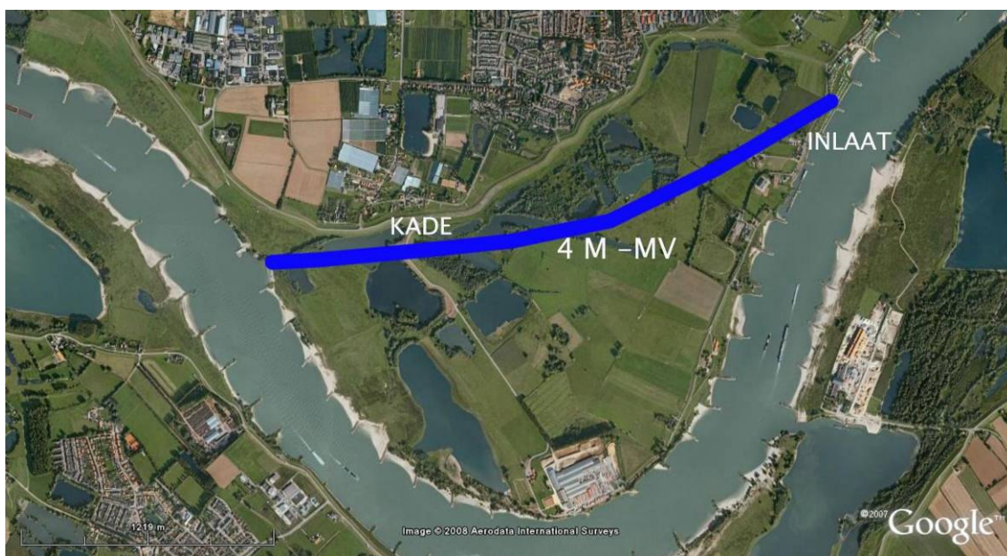
Afbeelding 25 Permanent meestromende nevengeul. De geul is geschematiseerd, en geeft niet het uiteindelijke tracé weer. De geul heeft een inlaat van 6 m +NAP en ligt 4 m beneden maaiveld in het grootste deel van de uiterwaard.
