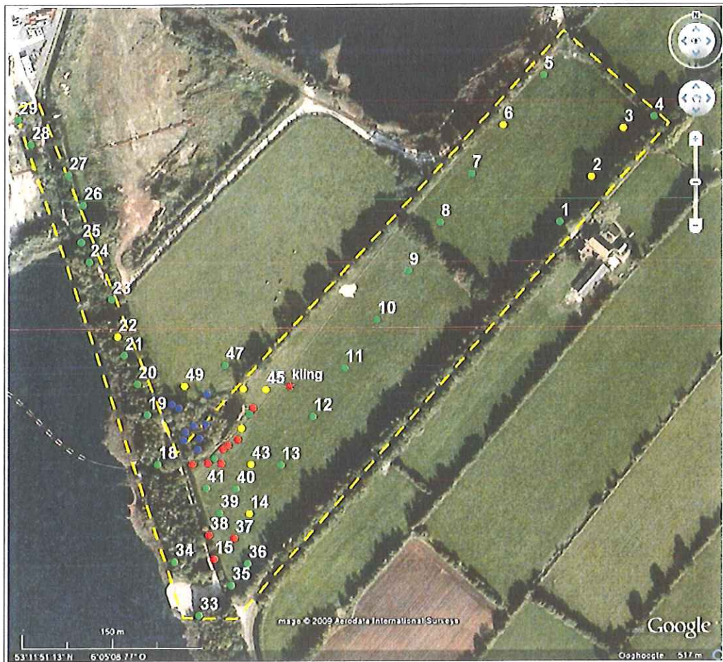
Figuur 5a: Drogeham, Zandwinning Westerein: boorpuntenkaart. De onderbroken witte lijn geeft de ligging van het onderzoeksgebied weer. De genummerde punten de ligging van de 60 boringen. De kleuren: rood = tenminste B-horizont podzolbodem aanwezig, geel = BC-horizont aanwezig maar B-horizont kapot, groen = bodem verstoord tot in C-horizont, blauw = intacte veenlaag aanwezig. Voor boornummers bij de dobbe, zie Figuur 5b. Ter plaatse van de rode ster is een kling(fragment) gevonden (zie Figuur 8).
