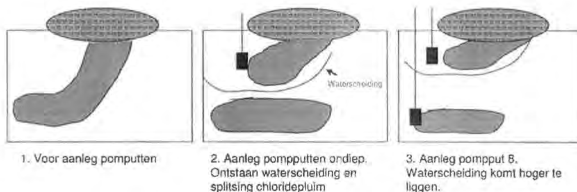
Figuur 14 Schematische weergave effect GBS ter plaatse van pompput 8
