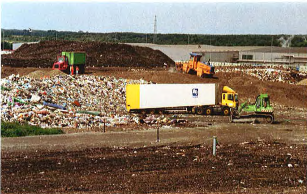
6. Oplegger met 'walking-floor' lost huishoudelijk afval direct op de stortplaats. Rijdt in 'lijndienst'.
