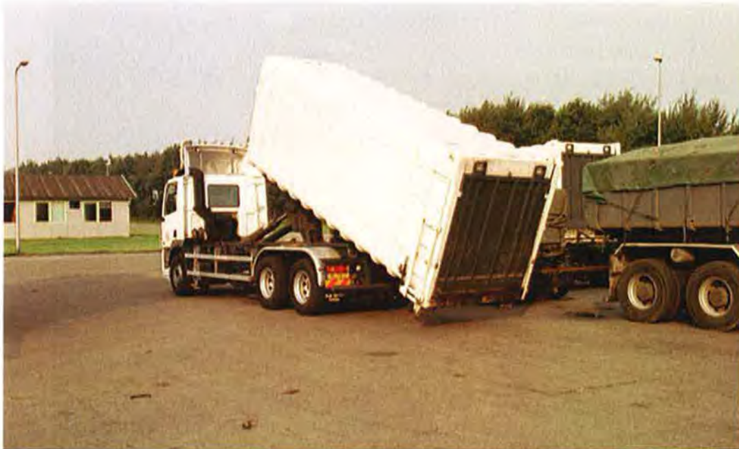
5. Truc met perscontainer (met huishoudelijk, of bedrijfsafval) op containerwisselplaats voor regionale aanvoer van (hha en ba) afval. Geen vervoersmiddel voor retourtransporten.
