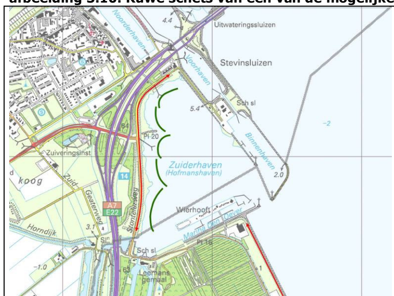
afbeelding 3.10. Ruwe schets van één van de mogelijke vormen van een vooroeverdam
