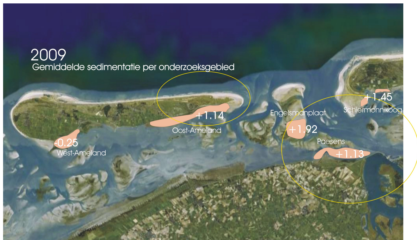
Figuur 20. Gemiddelde van alle sedimentatie metingen per onderzoeksgebied in het jaar 2009. Hiervoor is de gemiddelde hoogteligging in december 2008 met december 2009 vergeleken. Getallen in cm.
