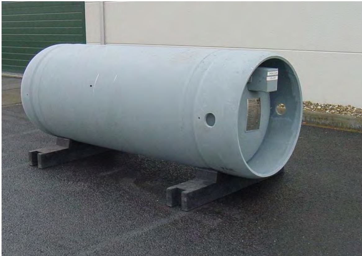
gestandaardiseerde container voor opslag UF 6
