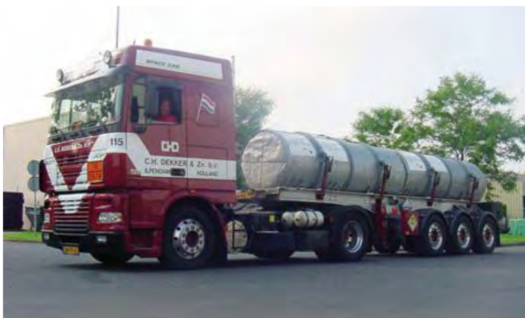
Foto S2 UF 6 -containers in beschermende verpakking
