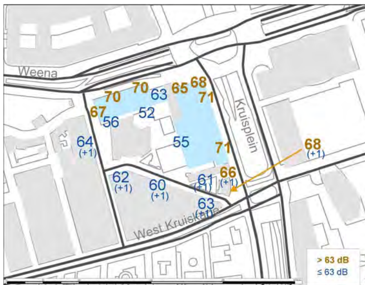
Figuur 8.10 Maximale geluidsbelasting op bestaande en nieuwe woningen als gevolg van het wegverkeer in de situatie na gebiedsontwikkeling RCD in 2021
