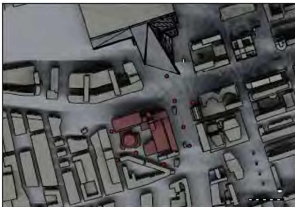
Figuur 14.5 Schaduwdiagram geplande onderbouw Weenapoint 21 maart-21 september
