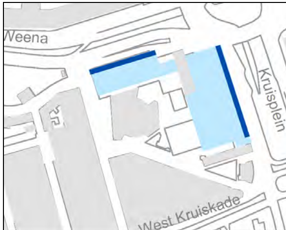
Figuur 8.13 Gevels met overschrijdingen van de Maximaal Toegestane Geluidbelasting.
