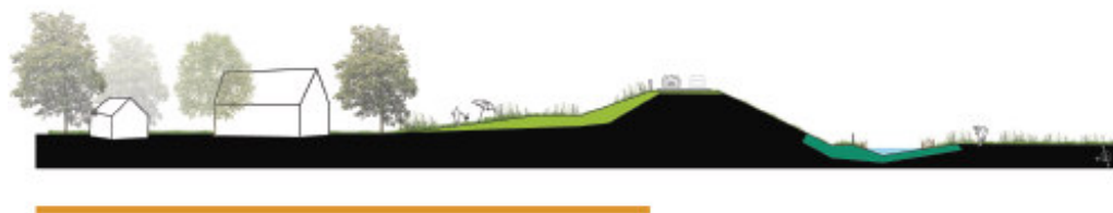
Oplossingsvoorkeur piping: Buitenwaarts ingraven van klei
