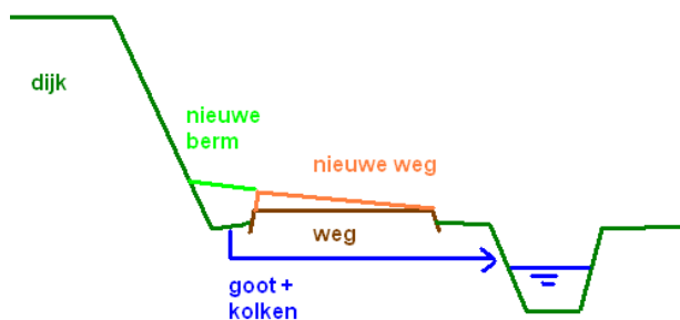
Figuur 26 Toepassing berm met verkanting
