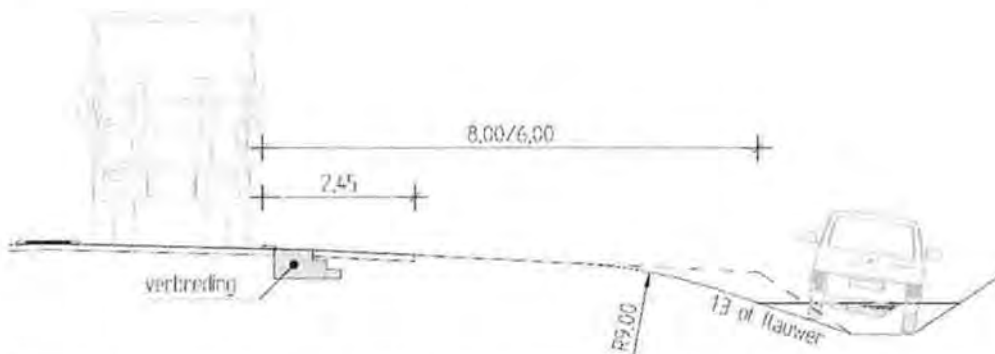
Figuur 3.9 Alternatieve inrichting ter plaatse van bestaande watergangen binnen de obstakelvrijzone
