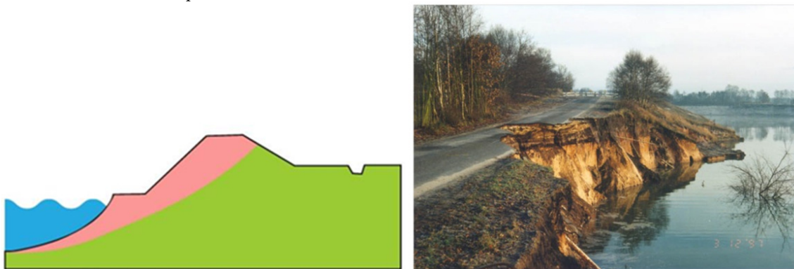
Afbeelding 8: Schematische weergave afschuiving voorland als faalmechanisme (l) [bron: helpdeskwater.nl] en praktijkvoorbeeld (r) [bron: Optimum, Informatie-magazine voor de GWW sector, Nr. 9, september 2002, blz. 6-9. D.R. Mastbergen, Th.P. Stoutjesdijk]
