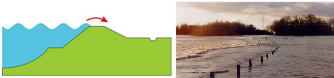
Afbeelding 7: Schematische weergave golfploop en -overslag als faalmechanisme (l) [bron: helpdeskwater.nl] en voorbeeld van een overstromende zomerkade (r).
