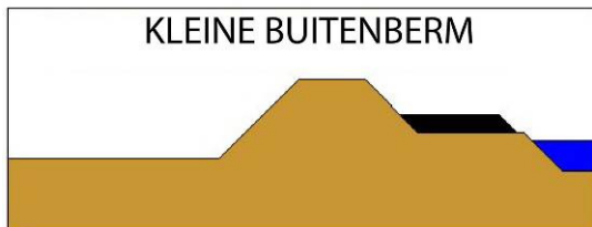
Afbeelding 14: Aanleg kleine buitenberm
