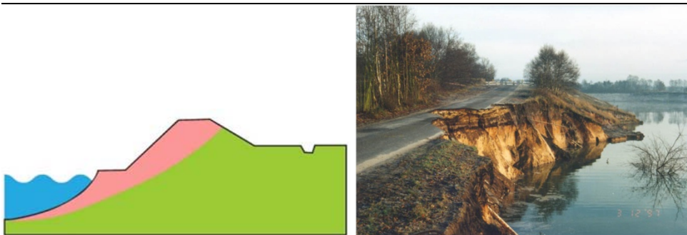
Figuur 2.3: Schematische weergave Afschuiving voorland als faalmechanisme (links) [bron: Ref 1] en praktijkvoorbeeld (rechts) [bron: Ref 3]
