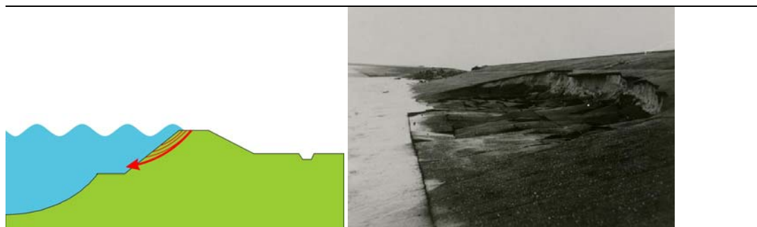
Figuur 2.4: Schematische weergave Bekleding buitentalud als faalmechanisme (links) [bron: Ref 1] en praktijkvoorbeeld (rechts, in dit geval geen grasbekleding maar een asfaltbekleding) [bron: Ref 4].
