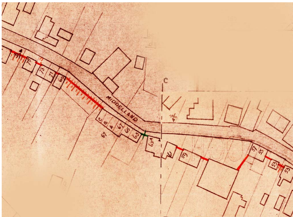
Ligging tijdelijke versterkingsmaatregelen 1957-1958 ter plekke van te versterken dijtraject 3 (Middelland)
