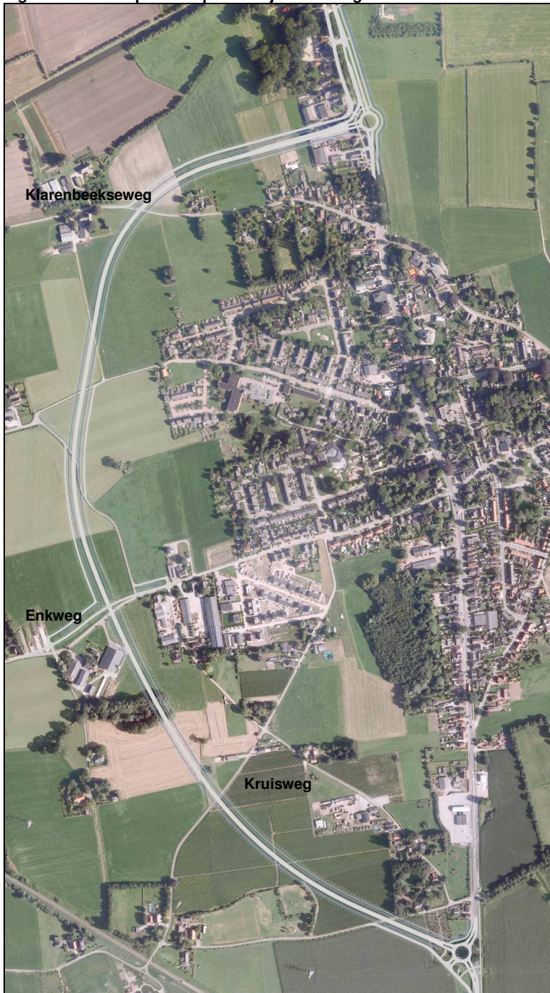
Figuur 3.1: conceptontwerp westelijke rondweg Voorst
