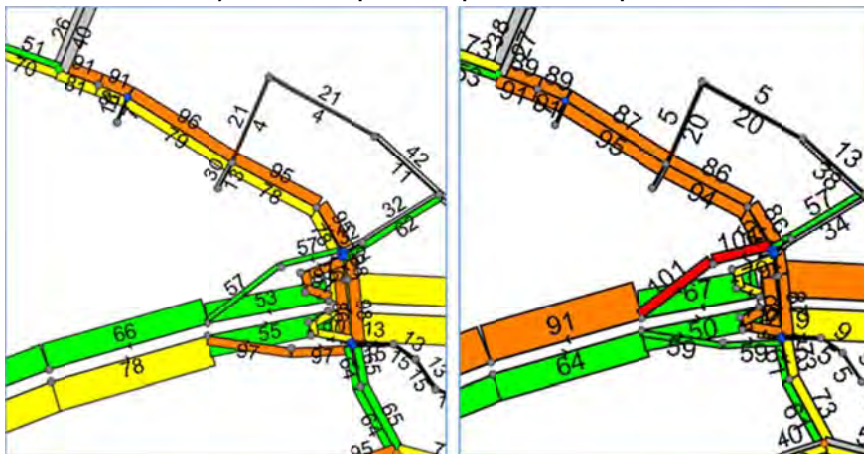
Figuur 6.4 Uitsnede I/C-waarden (%) robuustheidsanalyse 2022 Aansluiting A67/Eindhovenseweg in de ochtendspits (links) en avondspits (rechts)
