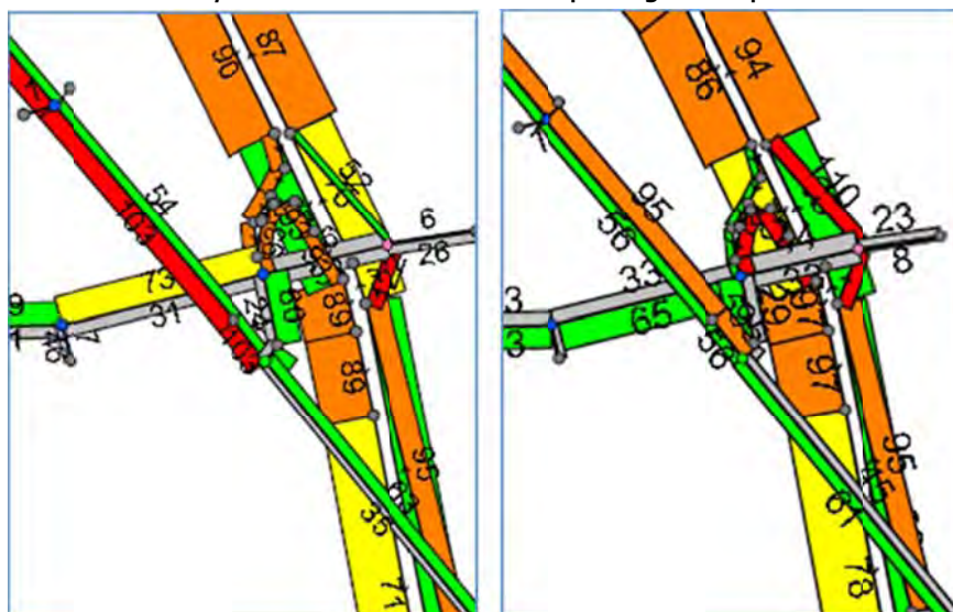
Figuur 6.7 Uitsnede I/C-waarden (%) robuustheidsanalyse 2030/2040 Aansluiting A73/GPL in de ochtendspits (links) en avondspits (rechts)
