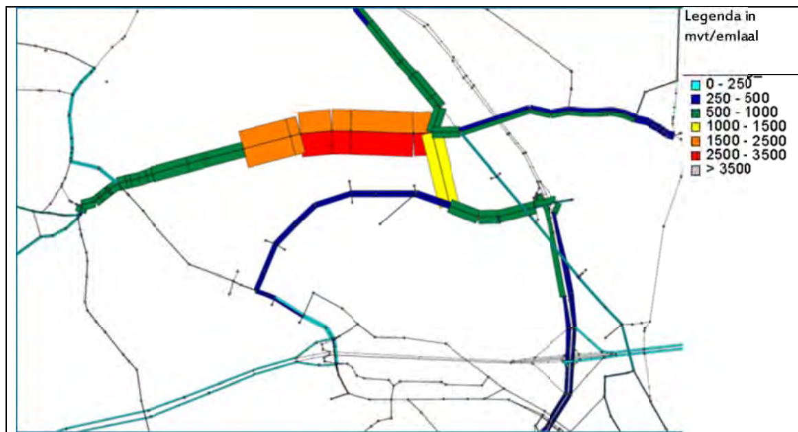
Figuur 6.10 Uitsnede selected link analyse Sevenumseweg VKA alternatief zonder 2e fase GPL
