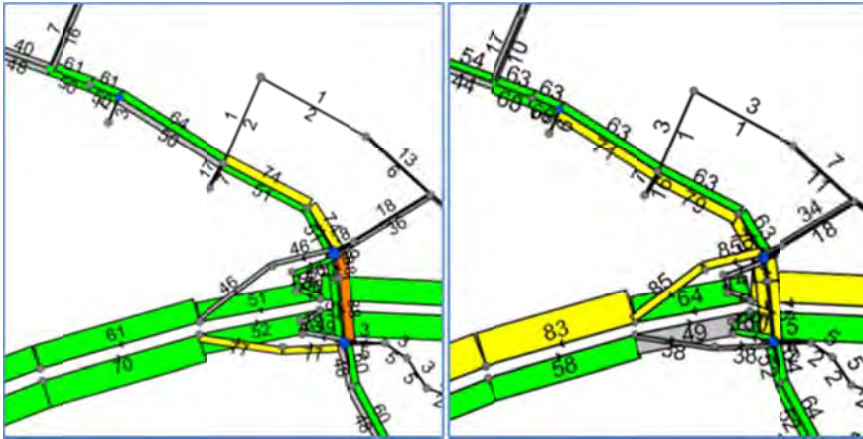
Figuur 6.1 Uitsnede I/C-waarden (%) autonome situatie 2022, A-aansluiting A67/Eindhovenseweg in de ochtendspits (links) en avondspits (rechts)
