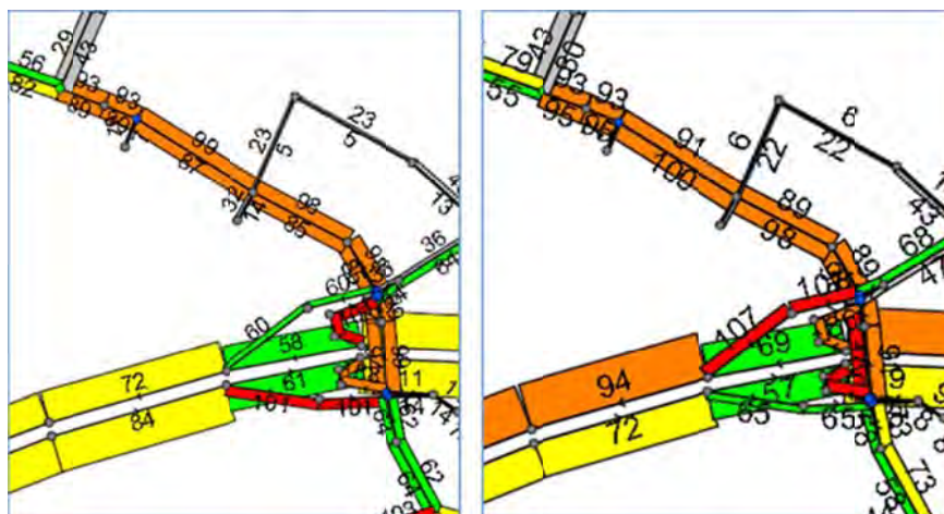
Figuur 6.6 Uitsnede I/C-waarden (%) robuustheidsanalyse 2030/2040 Aansluiting A67/Eindhovenseweg in de ochtendspits (links) en avondspits (rechts)
