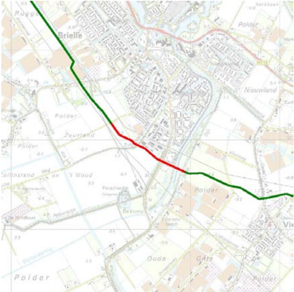
Figuur 5 Worst-casesegment van de A-536-KR-026 t/m 039, weergegeven in rood. Dit segment levert het hoogste groepsrisico op in de nieuwe situatie.
