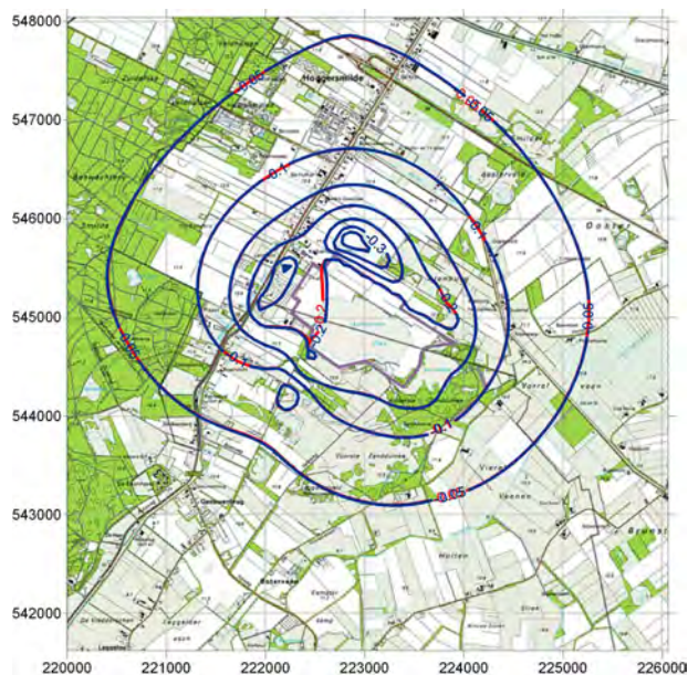
figuur 17 vergelijking tussen de uitkomsten van de gevoeligheidsanalyse ten opzichte van het effect in het 2 de watervoerende pakket bij een kD 1 m^2.d^{-1} (blauw) in plaats van 10 (rood) voor wvp1;
