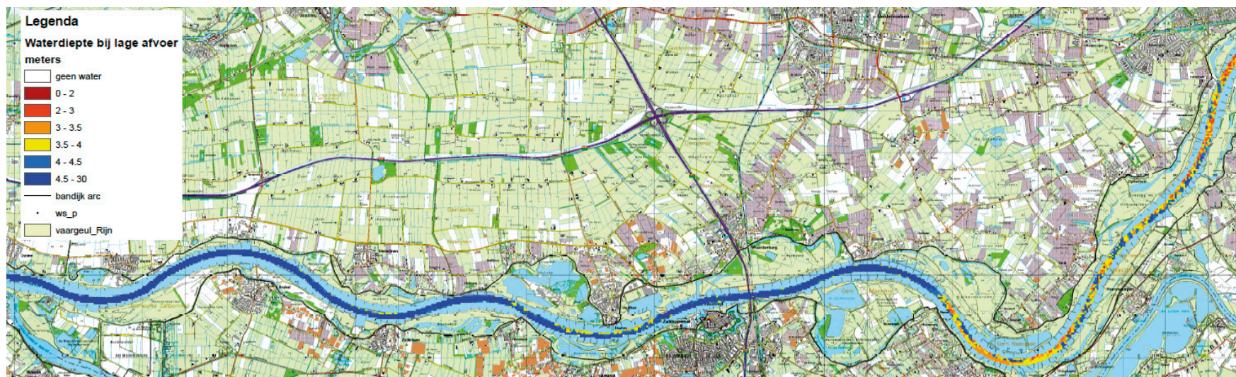
Afbeelding 11: Waterdiepte kaart bij lage afvoeren
