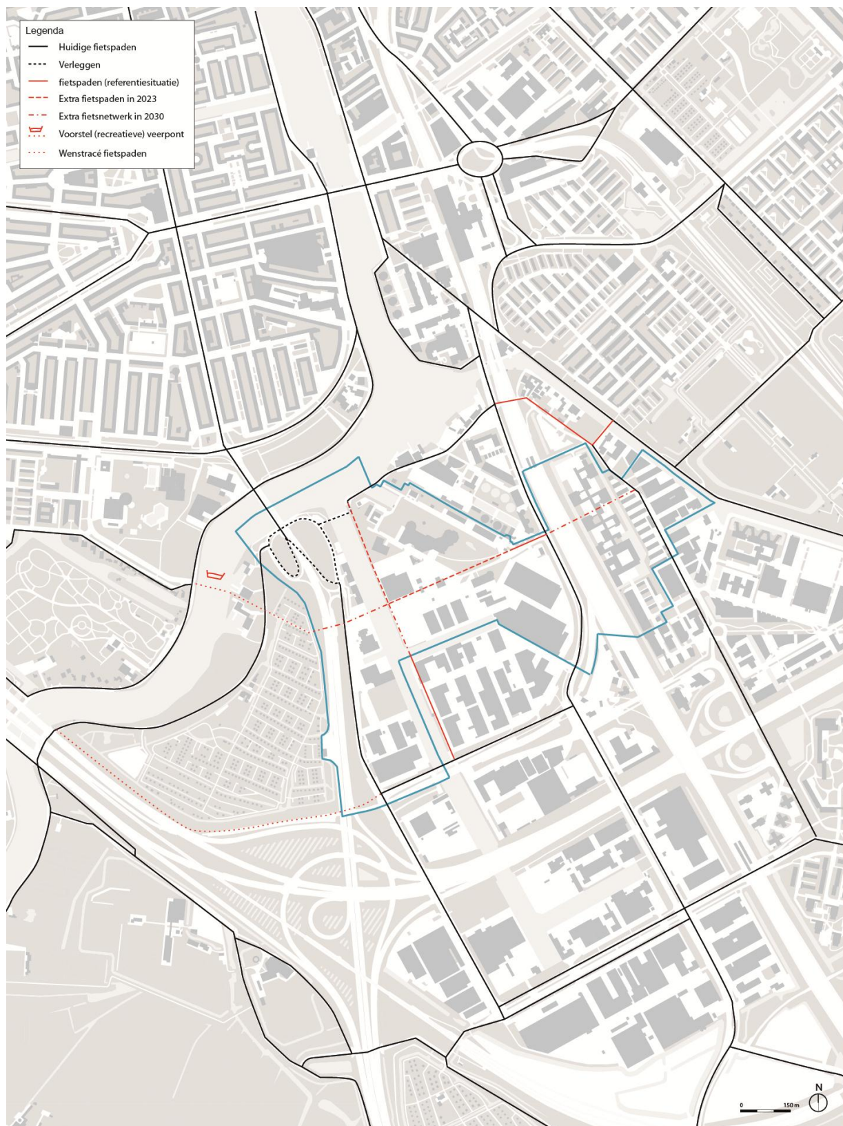
Figuur 7-10: de aanwezige fietsinfrastructuur in huidige situatie, 2023, 2030
