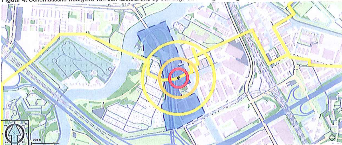
Figuur 4. Schematische weergave van een fakkelbrand op een hoge druk aardgasleiding.
