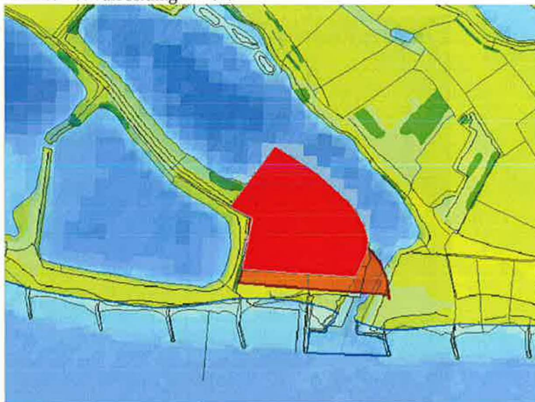
Figuur 6. In rood de ingetekende hoogwatervrije ophoging alternatief A. Oranje is alternatief B, groen is ondergrond.
