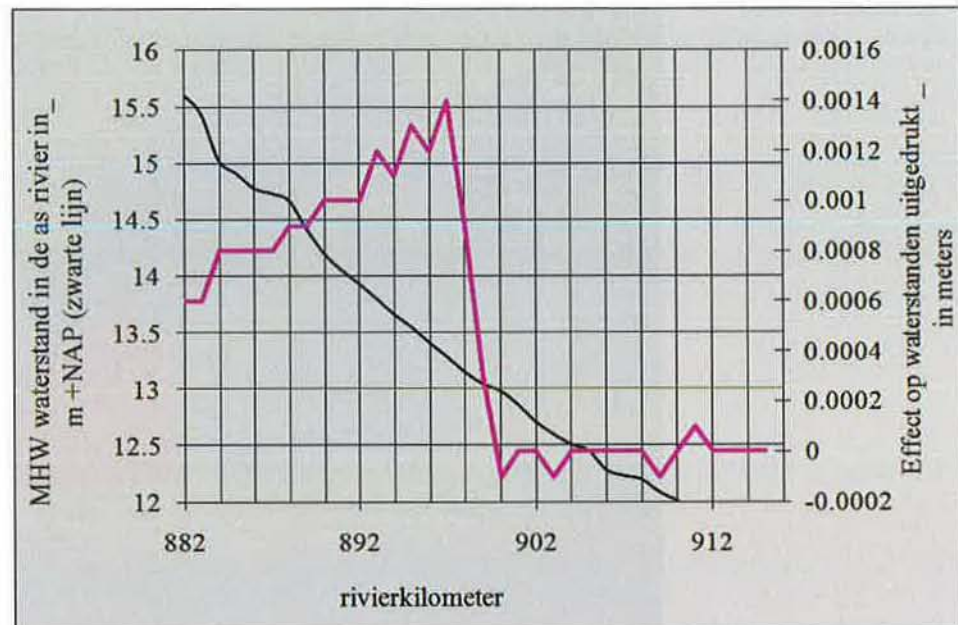
Figuur 17. De zwarte lijn met de bijbehorende linker y as geeft de waterhoogte weer, de paarse lijn met de bijbehorende rechter y as geeft het effect van de ingreep weer. Het maximale effect van Alternatief B met invaartopening, toegangsweg en depot bedraagt hier 1,4 mm. Referentie: Simona_rijn_pkb_3_2 met actualisatie van kieidepot en toegangsweg opgenomen in maptable 2.0.
