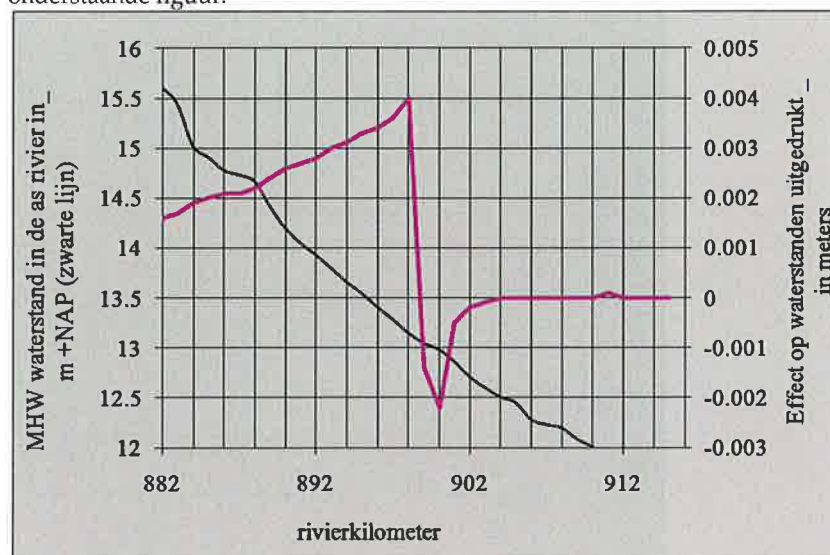
Figuur 9. De zwarte lijn met de bijbehorende linker y as geeft de waterhoogte weer, de paarse lijn met de bijbehorende rechter y as geeft het effect van de ingreep weer. Het maximale effect van Alternatief A met toegangsweg en depot bedraagt hier 4 mm. Referentie: Simona_rijn_pkb_3_2 met actualisatie van kleidepot en toegangsweg opgenomen in maptable 2.0.
