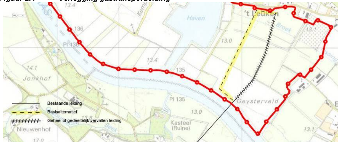
Figuur 2.4 Verlegging gastransportleiding
