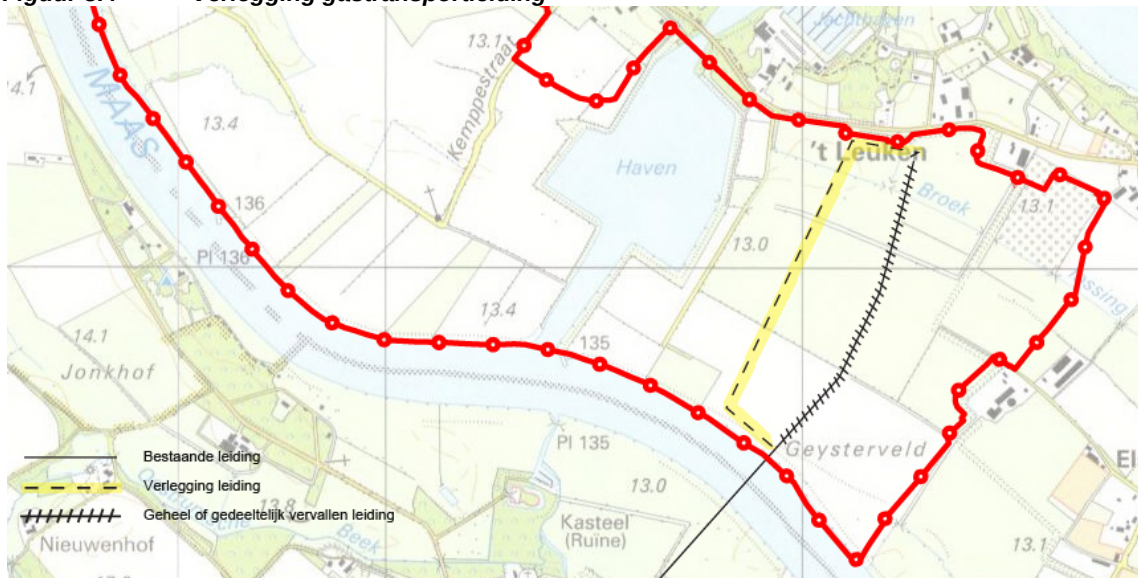
Figuur 3.4 Verlegging gastransportleiding
