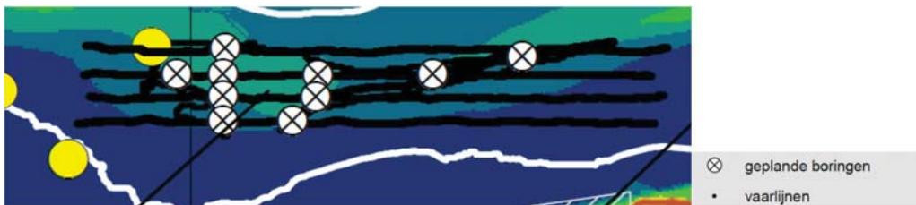
Figuur 4.1 Geplande boringen (kaart 2). Vaarlijnen zijn hier in zwart aangegeven. De boringen dienen om de aanwezigheid van stoorlagen te controleren, maar ook om aanvullende sedimenteigenschappen te bepalen.
