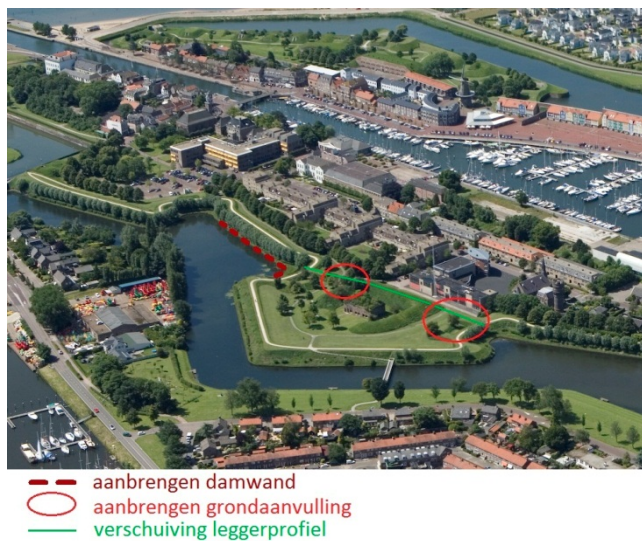
Afbeelding 8 Combinatie damwand en beperkte verschuiving leggerprofiel
