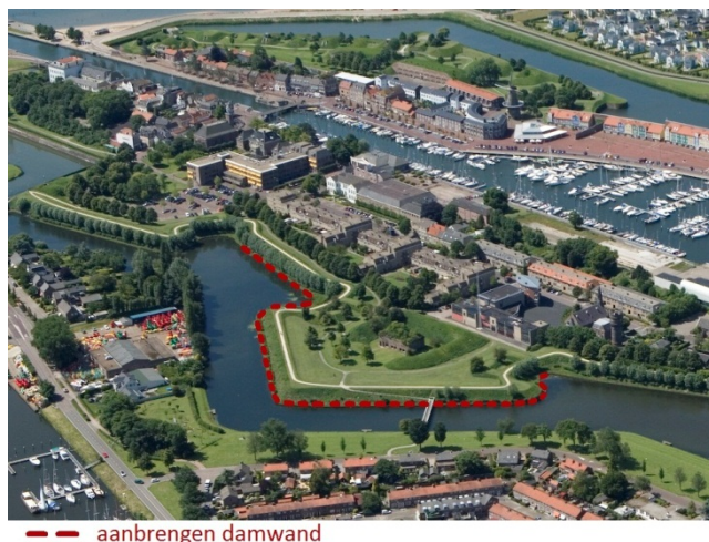
Afbeelding 11 Damwand over gehele tracé
