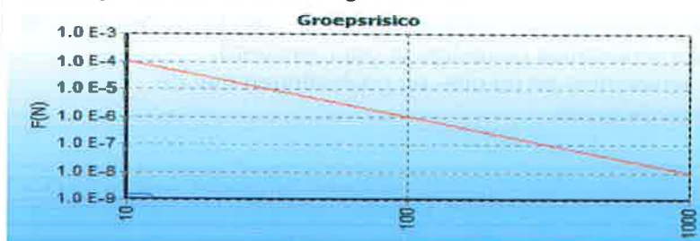
Figuur 5.6 FN curve voor A-516 van N.V. Nederlandse Gasunie voor de kilometer tussen stationing 41820.00 en stationing 42820.00.
