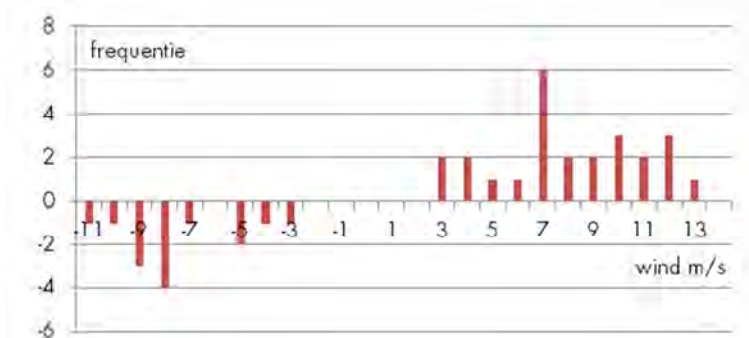
Figuur 7. Frequenties van windsnelheden en windrichtingen gedurende het voorjaarsonderzoek. Windsnelheden staan uitgedrukt op de x-as, waarbij negatieve waarden staan voor wind uit het zuiden en positieve waarden voor wind uit het noorden. Wind uit het noorden komt vaker voor dan wind uit het zuiden, maar de windkracht is overheersend matig met enkele uitschieters tot 13 mps vanuit het noorden. Windluwe dagen zijn schaars (data: KNMI Hoek van Holland).
