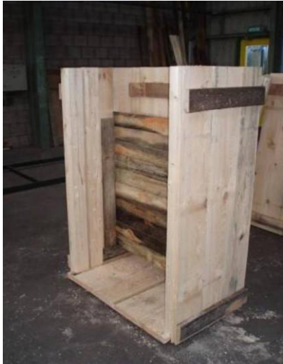
Figuur b5.5 Voorbeeld van kleine slibkisten van de Fa. vd Sijde; in voor- en achteraanzicht; voor het onderhavige werk zullen (veel) grotere kisten worden ingezet, volgens hetzelfde principe
